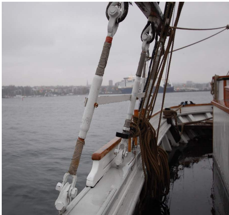
Nærmest ses en strekkfisk hvor begge ender har en mansjett. Den øvre går opp på hylsa, slik det skal være, mens den nedre først starter under hylsa. Som beskrevet i teksten bør begge gå litt inn på hylsa. Bildet viser også ei skinne som er skrudd fast i senter av strekkfisker og hindrer denne i å gjenge seg ut.
