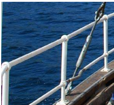
Her er rør-rekka tilpasset slik at strekkfisker får fritt leide. Strekkfisker skal monteres slik at den ikke bøyes ved oppstramning.
