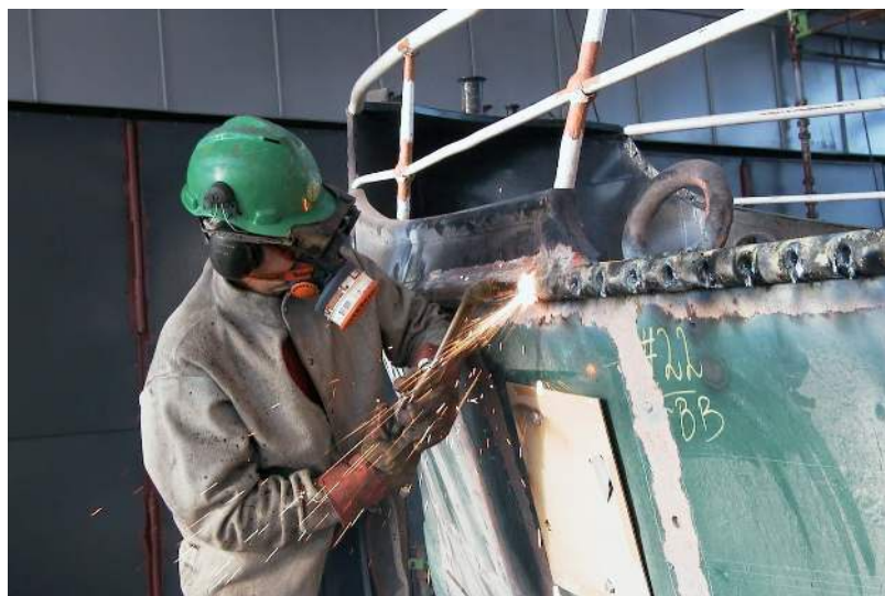
Utbrenning av nagler i fenderlist (foto: BDF)
