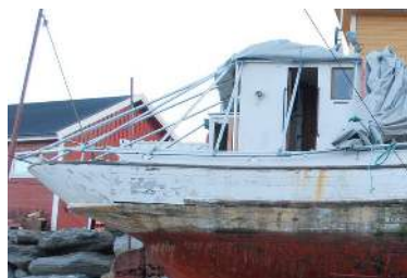
Reisverket er bygget opp av 2" aluminiumsrør som er satt sammen med beslag som skal gnage minst mulig på presenningen.
