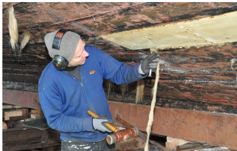
Båtbyggeren setter drevet i små løkker. Bakom stikker noen drevender ut av natene. Når en ikke driver hele naten avslutter en slik istedenfor å la tråden forsvinne helt i naten, - dette for å holde oversikt over hvor det er drevet.
