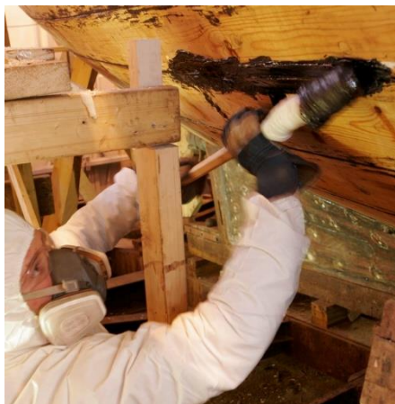
Et skaft surret med ei bomullsfille fungerer fint som bekkost. Kosten må gjerne roteres gnikkes med for å få beket skikkelig inn i natene.
