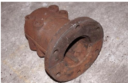
Koblingsflens. Slike monteres på akslingene på utgående aksling fra motor, og på propellaksling, for så å skrur sammen mot hverandre.
