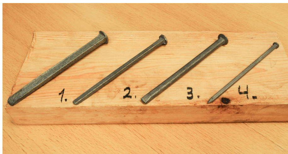
Skaftedoren brukes når spikeren skal inn i forsenkinga. Her brukes f.eks. smihammer til slagverktøy.
