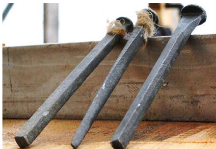
Spiker levert i pakning fra norsk spikerprodusent. Egentlig produsert i Skotland. Varierende utforming, og lite lik den opprinnelige norske skipsspikeren.
