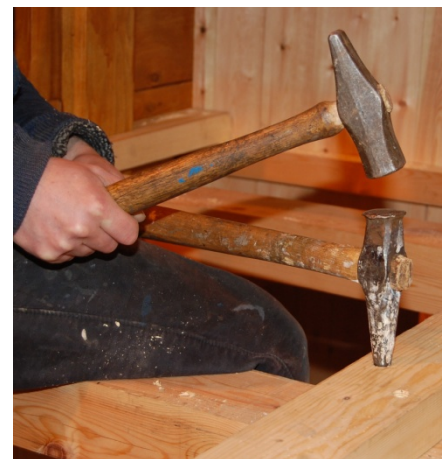
Skaftedoren brukes når spikeren skal inn i forsenkinga. Her brukes f.eks. smihammer til slagverktøy.
