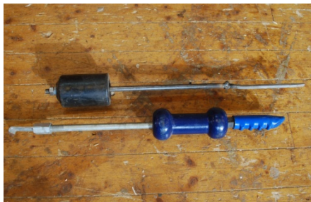
Bolttrekkere. Den ene sveises til boltens/spikerens hode, mens den andre griper tak under hodet på bolten/spikeren.
