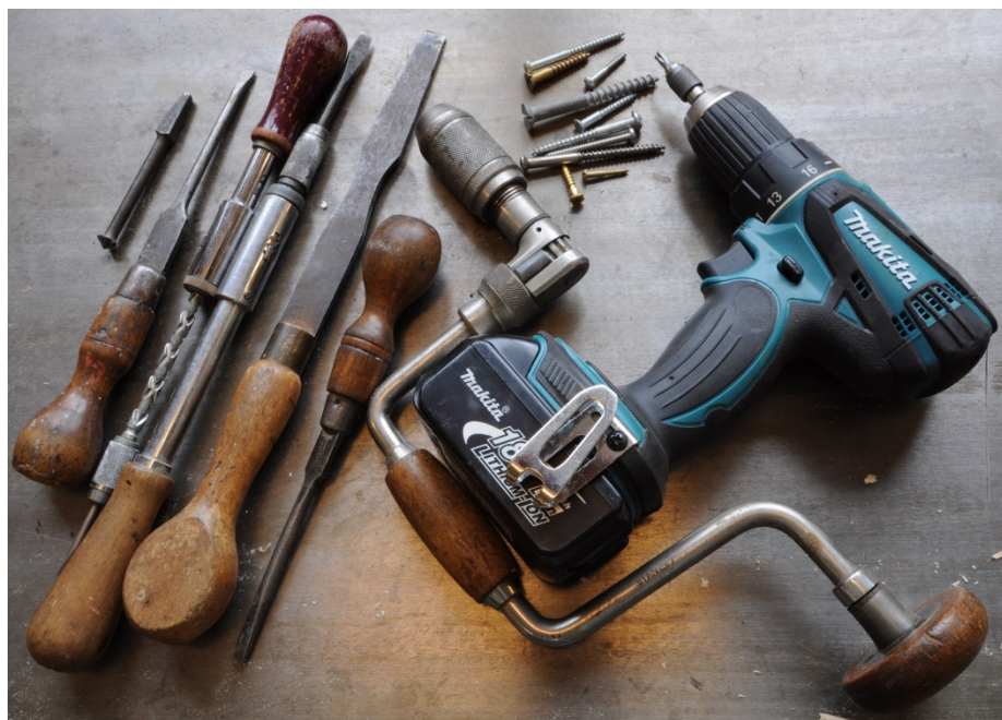
Ulike skruverktøy. Borevinna er utmerket til å løsne skruer som sitter godt. En må da imidlertid ha passende skrujern for jobben. Ellers ser vi et par pumpeskrutrekker og ulike eldre skrujern/meisler. Legg merke til at de eldre skrujernene har anlegg for skiftenøkkel
