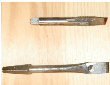
Øverst en skrumeisel for maskin laget av en slitt gjengetapp, og nederst en skrumeisel for borevinne.
