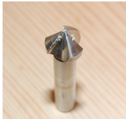
Forsenkere finnes i mange utførelser, - denne er beregnet på stål, men fungerer også fint på tre. Forsenkere for tre har normalt samme koniske form som denne, men ett skjær.
