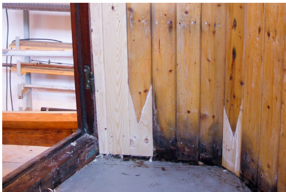
Et forsøk på å bevare mest mulig av de opprinnelige panelene i styrhuset på «RS Biskop Hvoslef». Råteskadde deler er byttet ut med frisk materiale av tilsvarende kvalitet. NNFA.
