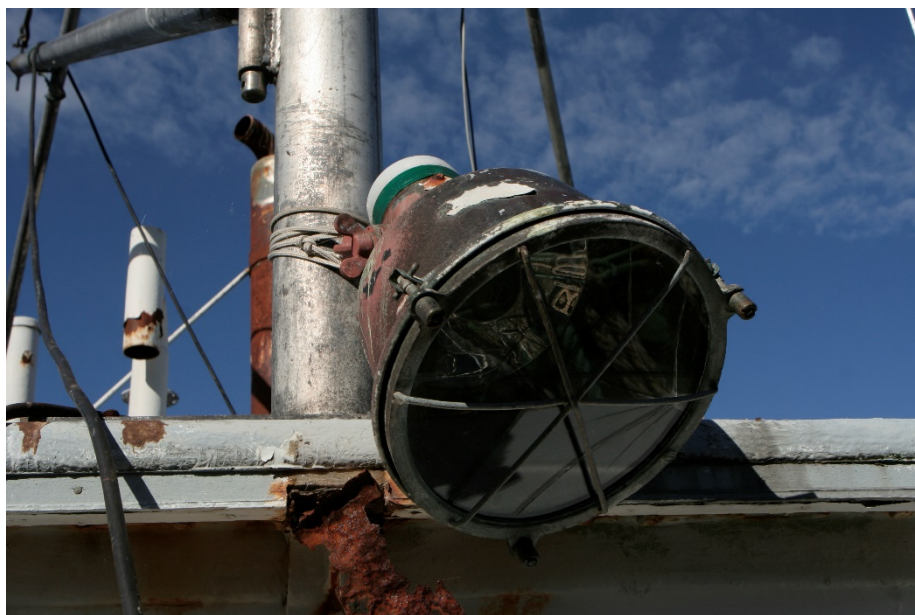
Denne arbeidslampe er kanskje i dårlig forfatning, men den har fortsatt sine skjøreste deler intakt. Den kan dermed bli «donor» for å istandsette ei tilsvarende lampe.
