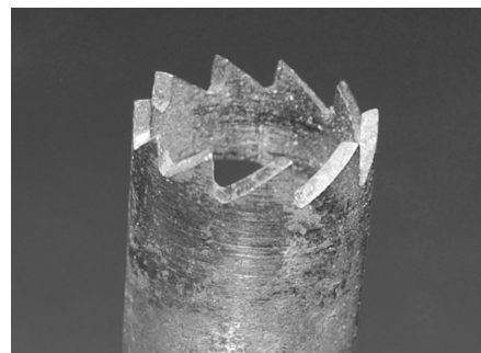
Eksempel på bor laget av rør.
