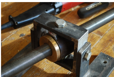
Stanga til boreutstyret er opphengt på inn- og utsiden av skroget. Ved det ene stativet består opplagringa av ei messingforing med gjenger slik at stanga driver skjærene gjennom materialet.
