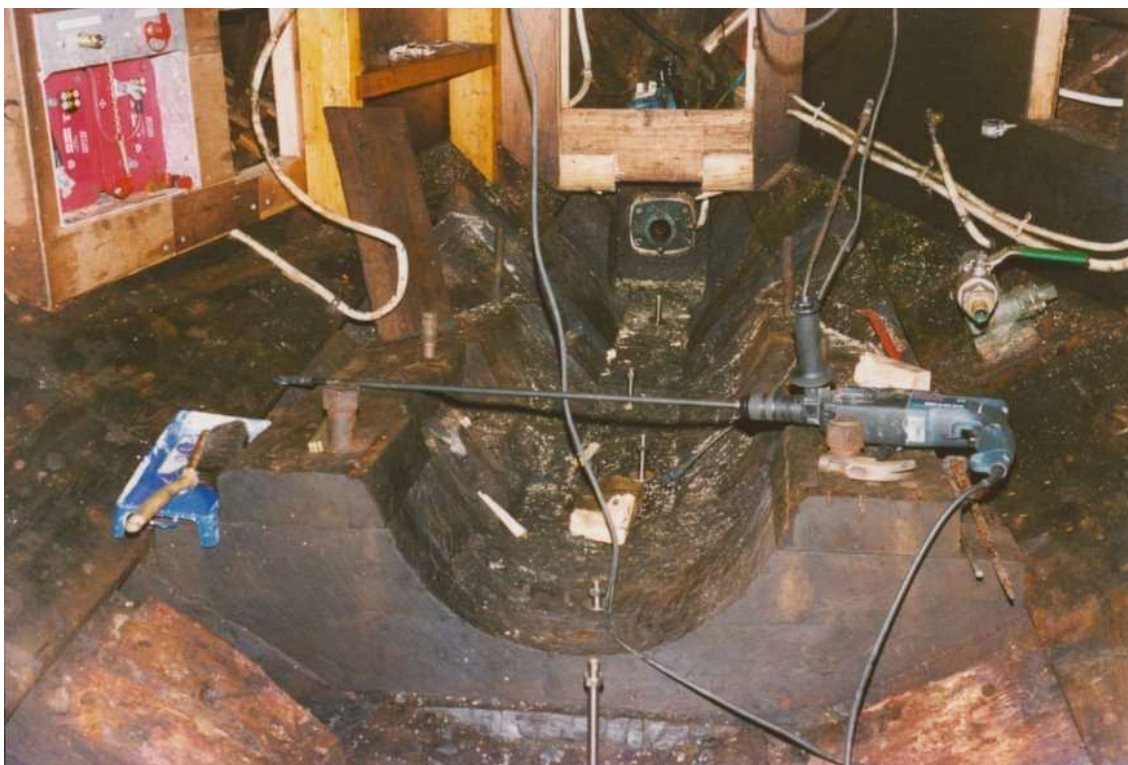
Figur 93: Fotograf: Ove Skylstad. Skifting av kjølboltar ved Bjørnevik Slipp i 2002. Frå post på Facebookprofilen «Taffjorbåten» lagt ut 17.nov. 2011
