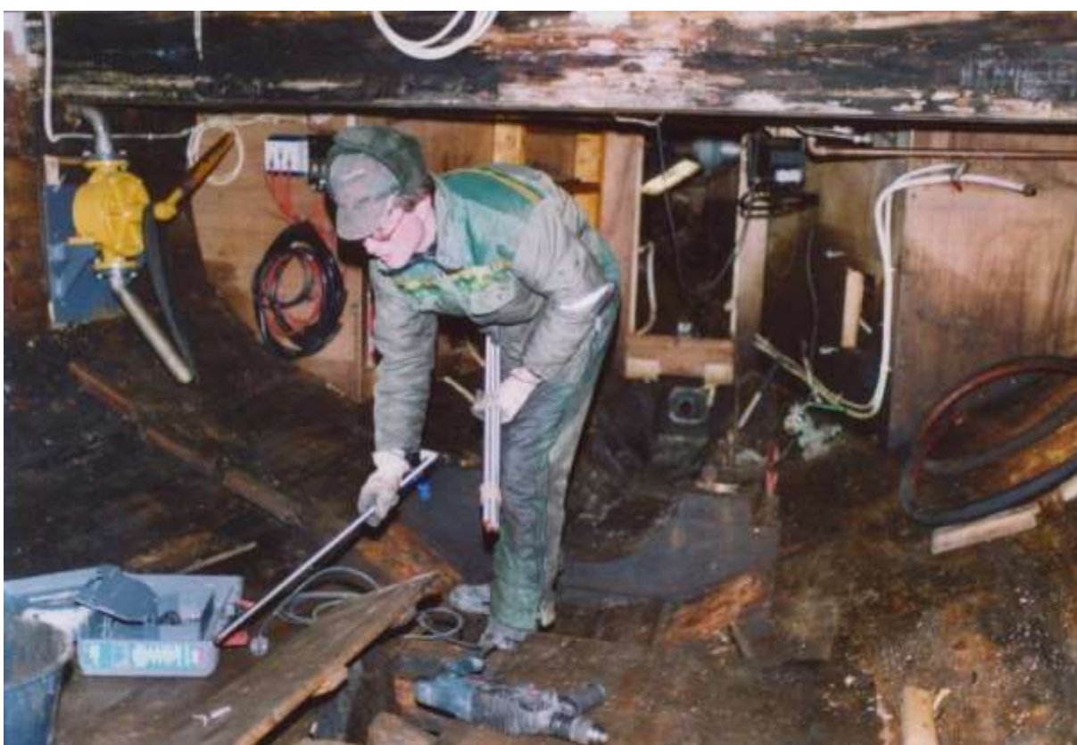
Figur 96: Fotograf: Ove Skylstad. Skifting av kjølboltar ved Bjørnevik Slipp i 2002. Frå post på Facebookprofilen «Tafjordbåten» lagt ut 17.nov. 2011
