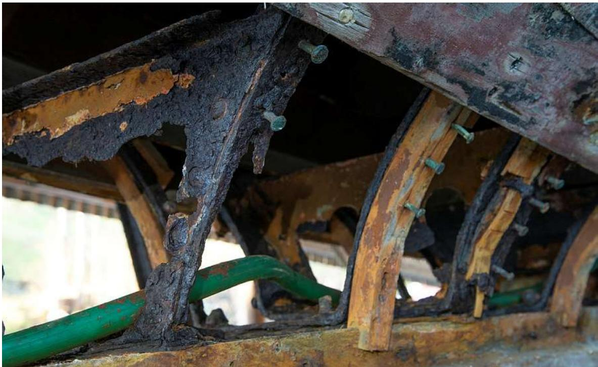
Figur 46: Festepunkt for spanta i botnstokk. Fig. Kjølen er festa til botnstokken med lange kjølboltar. Stålkonstruksjonen er kraftig korrodert nede ved kjølen. Lenger opp er tilstanden langt betre.
