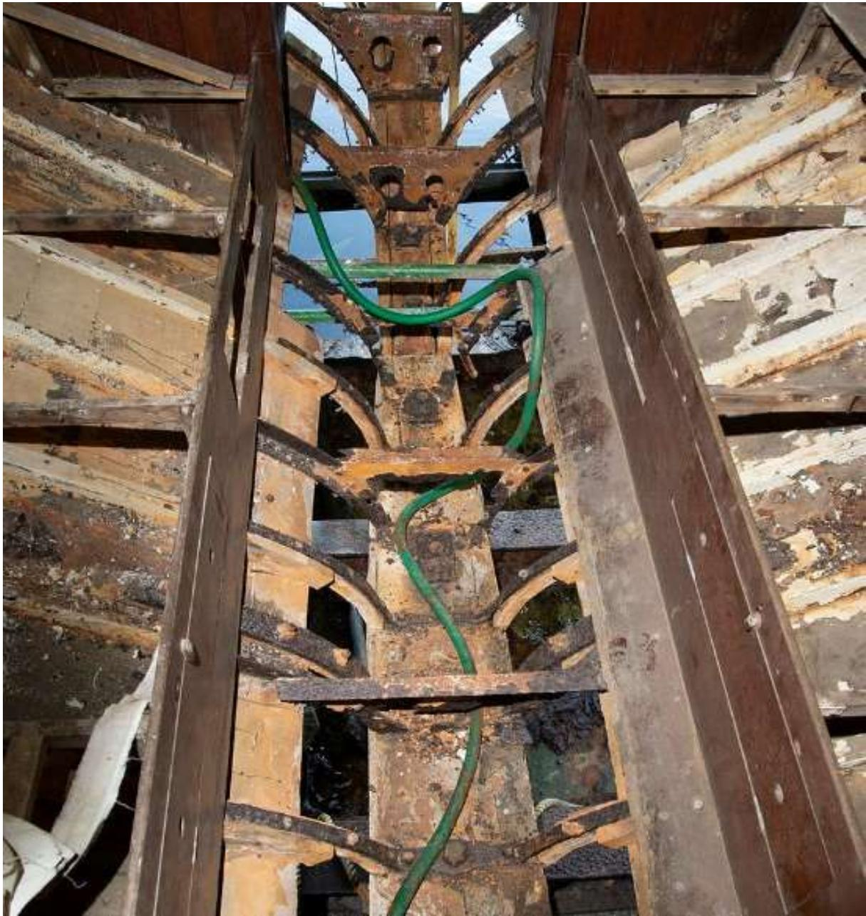
Figur 45: Grunn-konstruksjonen består av botnstokk/kjøl, botnstokkplater i stål festa til vinkelstål-spant, stålpant (flatt stål)på ribber, og smijarn. Annakvart spant er laga i vinkelstål, bunde sammen med botnstokkplater og festa i botnstokken. Spanta mellom desse er ribber i alm, forsterka med flatt stål. Kvart «spantesett» er festa med to boltar gjennom botnstokken, og med kjølbotn ned til underkanten av blykjølen.
