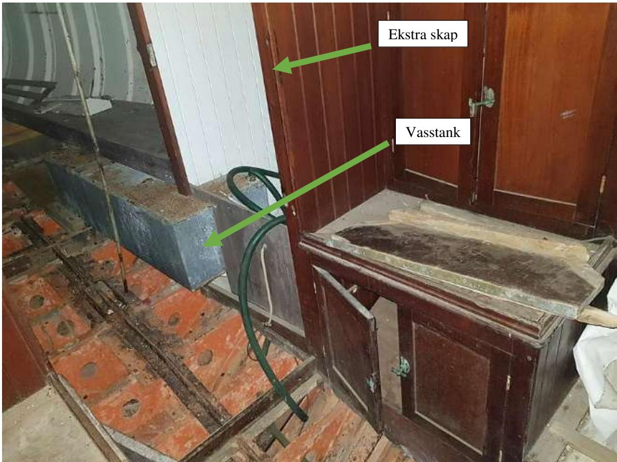
Figur 16: Ifølgje teikninga frå 1920 er det eit ekstra skap på SB side. Som me ser på biletet kjem vasstanken no inn i dette skapet. Vasstanken finst ikkje på teikningane.
