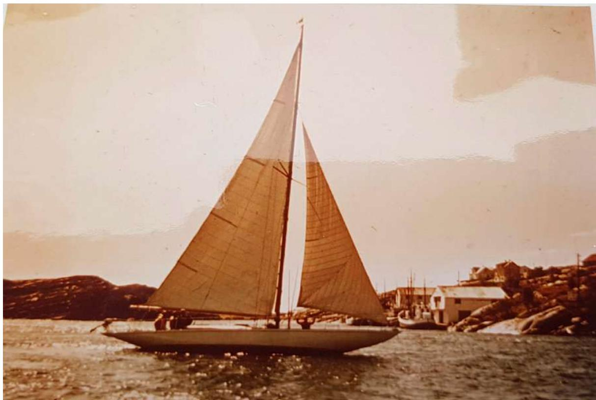
Figur 25: Brand VI under segling, truleg ein gong på 60-talet. Her ser ein tydeleg at båten er utstyrt med hjelphemotor på hekken. Ein kan også skimte rekkestøtter med sikringswire. Her kan ein også sjå at masta er blitt kortare. Det øvste salingshornet er borte, og seglet er av eit anna fabrikat.
