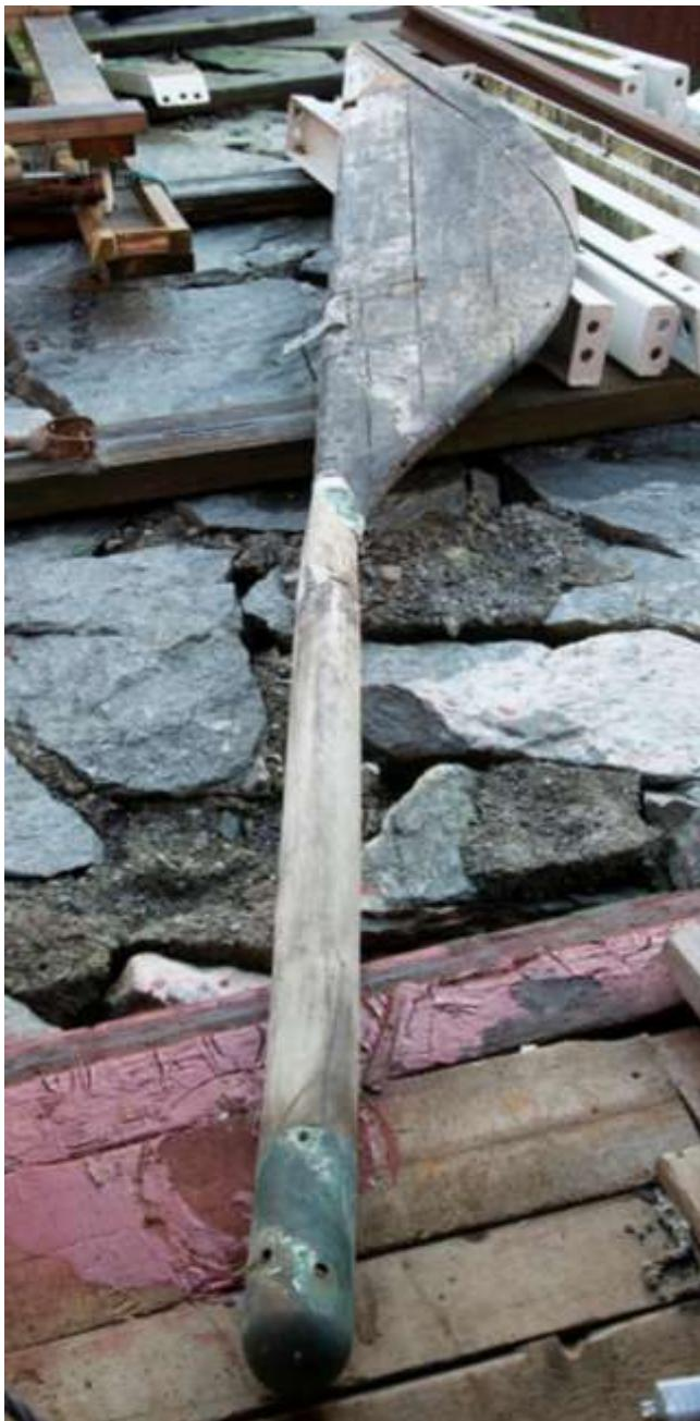
*Figur 60: Me kan sjå at roret er føra på i akterkant. Når og kvifor dette er gjort veit me ikkje. Det er nærliggjande å tru at roret har vore i minste laget og at ein har ønska litt meir effekt under segling, sidan det er gjort i akterkant. Det er der effekten av roret er størst.*
