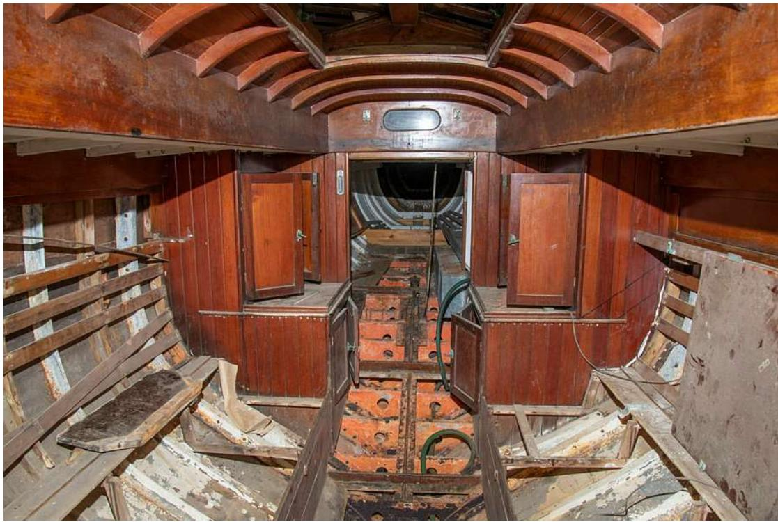
Figur 56: Foto som viser interiøret under skylight. Fartøyet har ein todekt sofa, ein del på SB side og ein på BB side, med skap under. Dette er i tråd med teikninga frå 1920.
