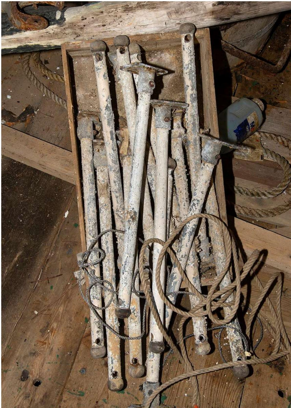
Figur 65: Rekkestøtter. Desse vart montert i lystbåt-perioden.
