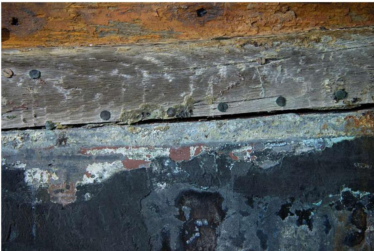
Figur 52: Utsnitt frå overgangen mellom blykjølen og skroget.
