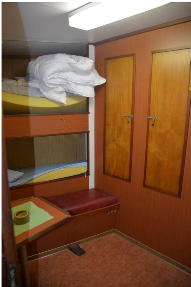
Figur 13 Skap med skrog av plater med mahognioverflate. 2 mannslugar under hoveddekk. Foto HFS 2020
