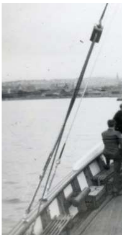
figur 36: Vanter til lasteriggen (utsnitt av figur 129).
