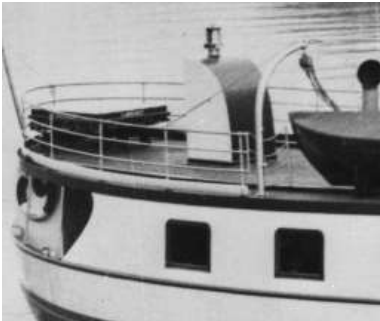
figur 93: Nedgangskappe, ca. 1950-77 (utsnitt av figur 54).
