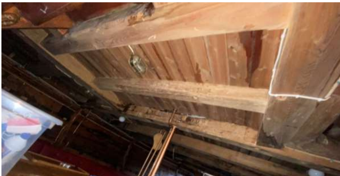
figur 84: Dekkshjelker med to kraveller, mulig spor etter gammel skylight
