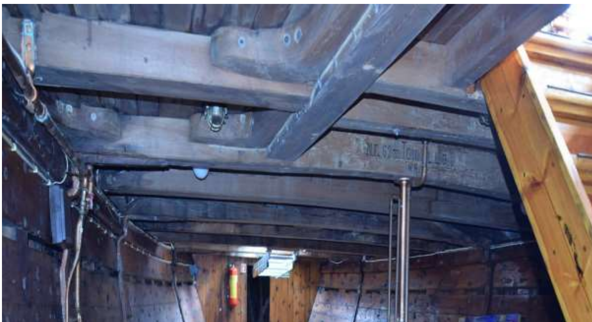
figur 57: Original luke til ruff med kraveller og fem par knær, 2015.
