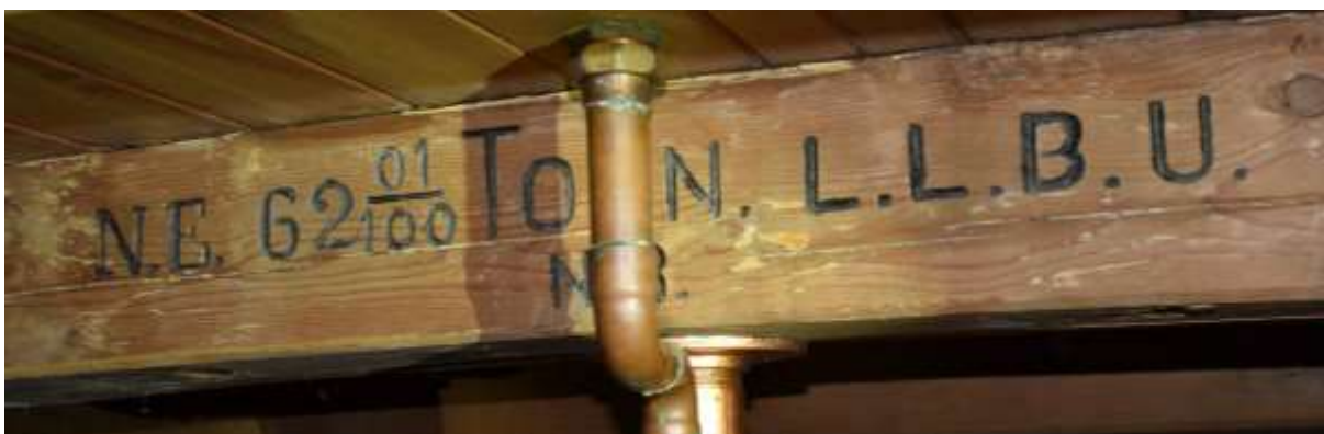
figur 58: Dekksbjelke med nettotonn og kjenningssignal innrisset, 2015.
