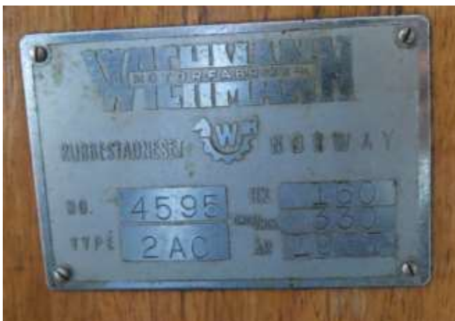
figur 87: Maskinskilt på manøvreringssøyle.
