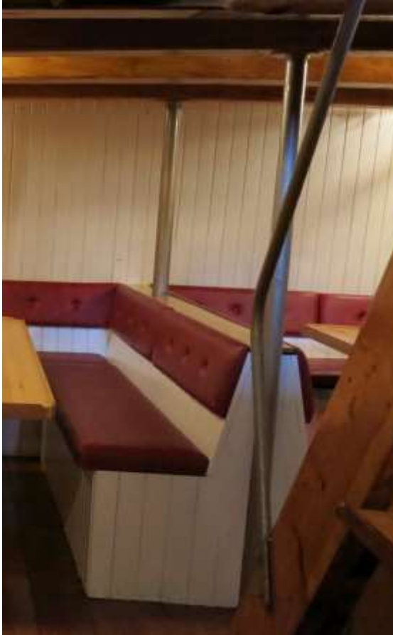
figur 13: 2 av 3 jernstøtter som fremdeles finnes i passasjersalongen (130) under dekk. Det er spor etter en fjerde i dørk og bjelkelag lengst forut, 2015.
