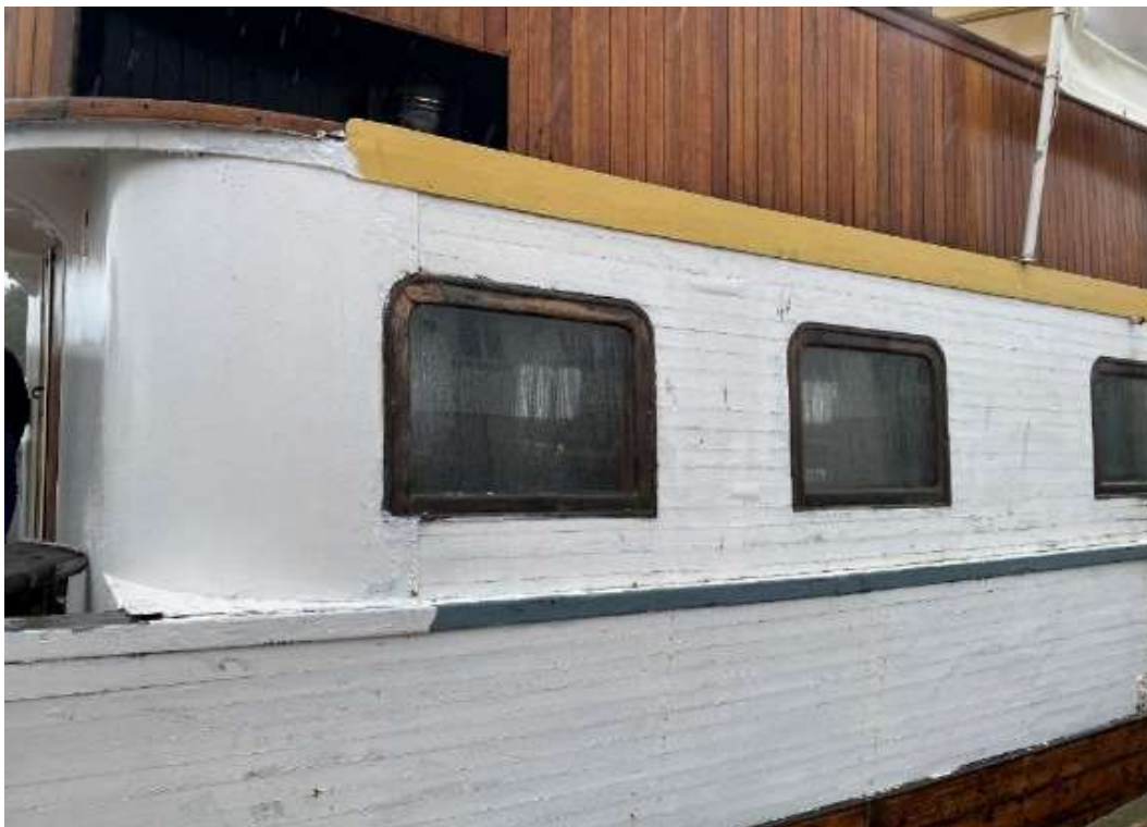
figur 64: Overbygg i tre med stålskjerm i front, 2021.
