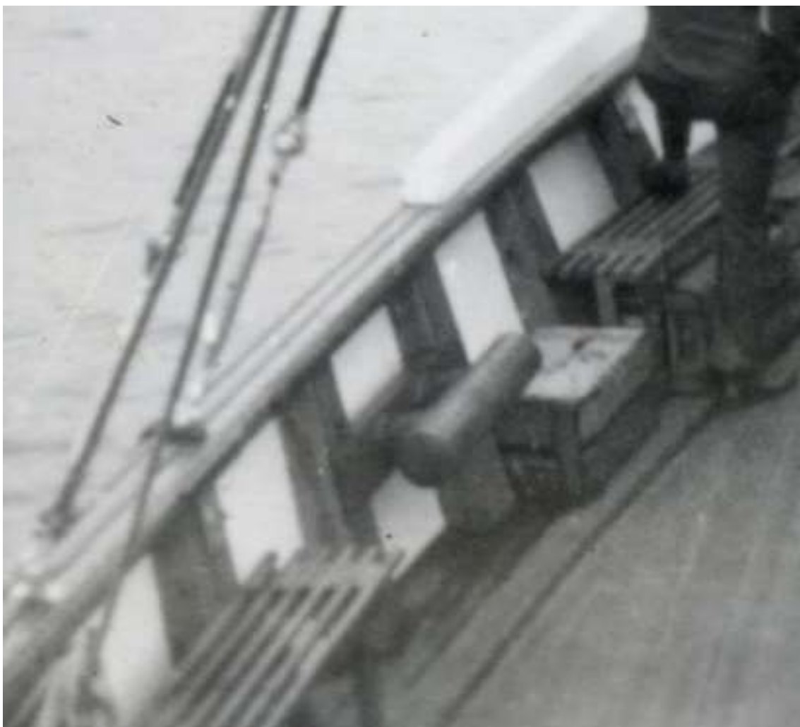
figur 98: Fordekk (210). Benkearrangement langs rekkestøttene, 1946 (Utsnitt av figur 129).
