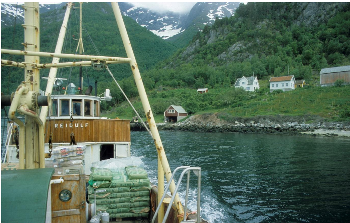
Figur 40 Foto Helge Sunde, 1984. Her er skorsteinen fjernet, og et eksosrør stikker nå skrått opp fra styrehuystaket.
