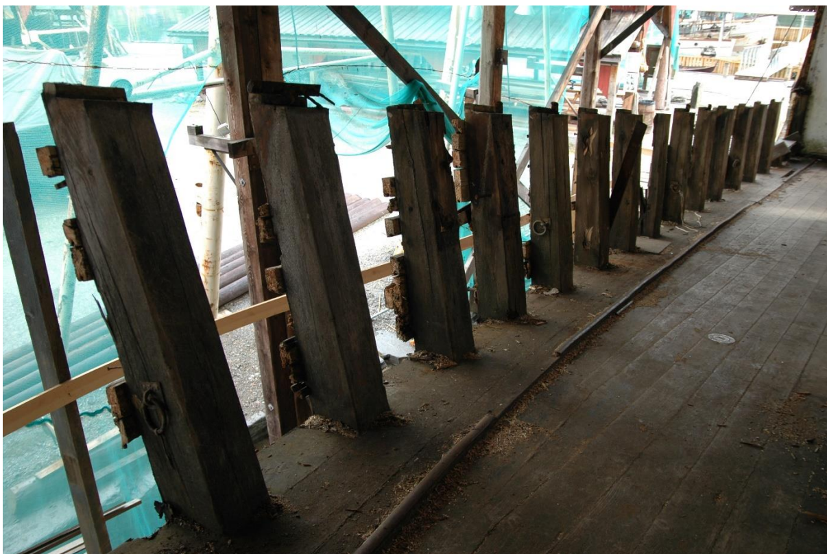
Figur 55 Foto HFS. Fotoet fra 2005 viser at det var usedvanlig tett mellom rekkestøttene. I 2005 skiftet HFS ut rekkestøtter og satte da kun opp hver annen fra dekkshuset og fram. Noe lengre har man ikke kommet i restaureringa etter den tid.
