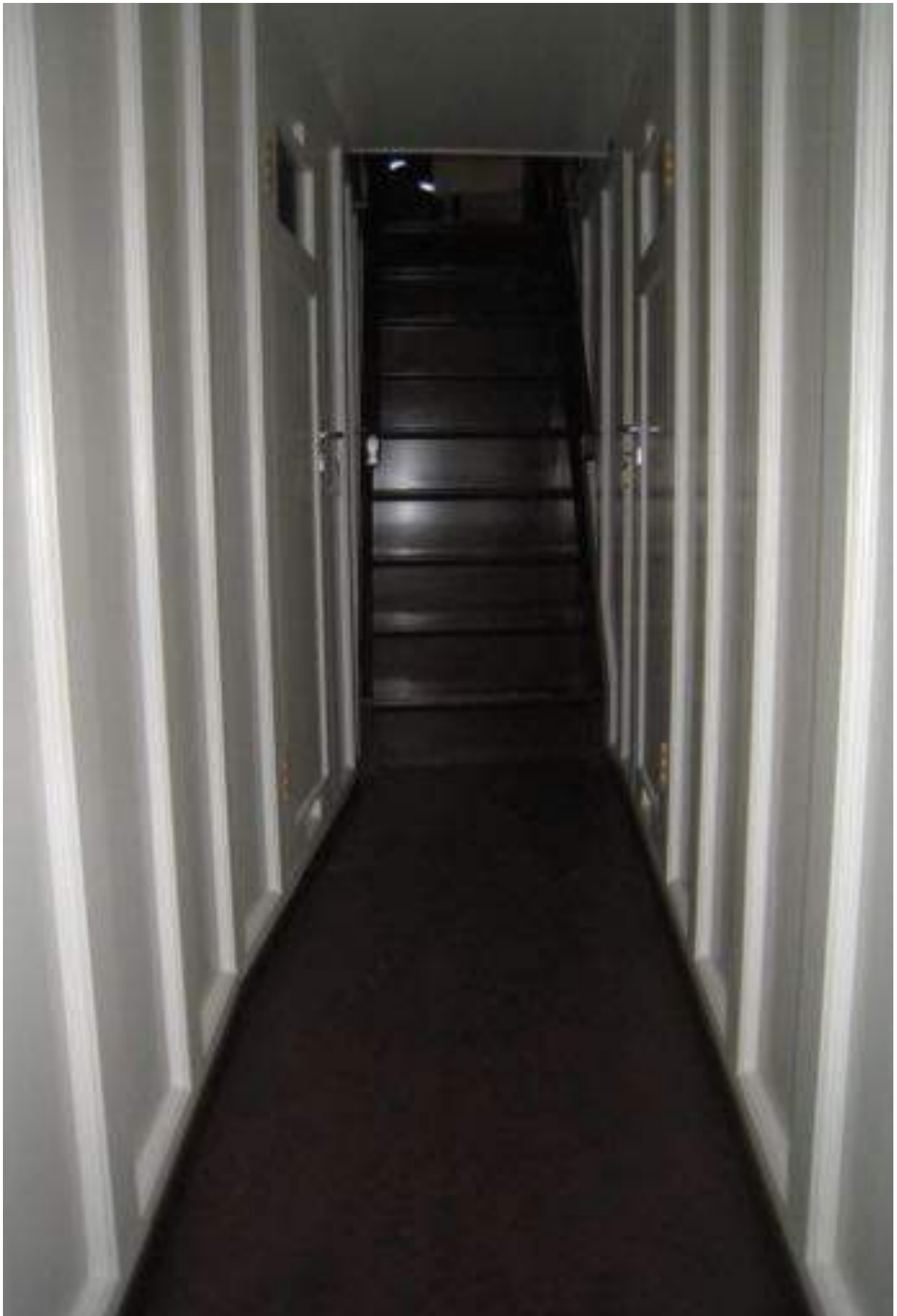
Ferdig korridor sett forover med linolumsbelegg og trapp i mahogni opp til hoveddekk.
