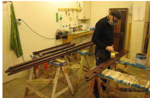
Meklar og bunramme for spiler blir tilpassa, beisa og lakka.
