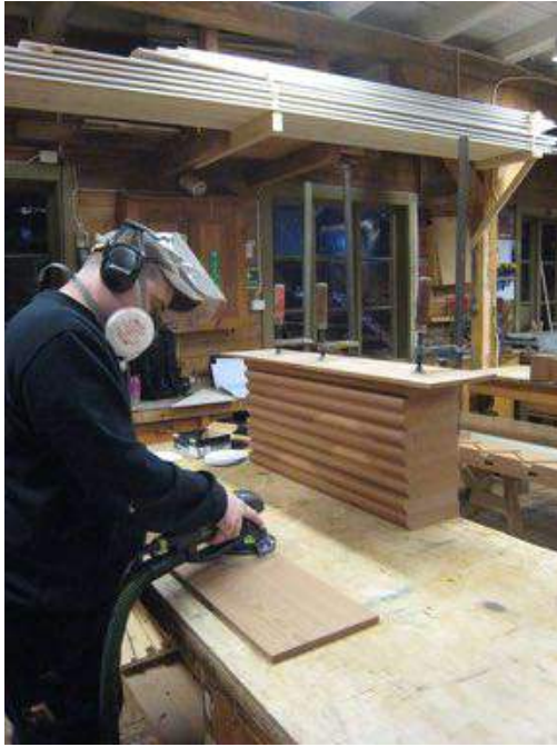
Opptrinn og trappetrinn blir pussa.
