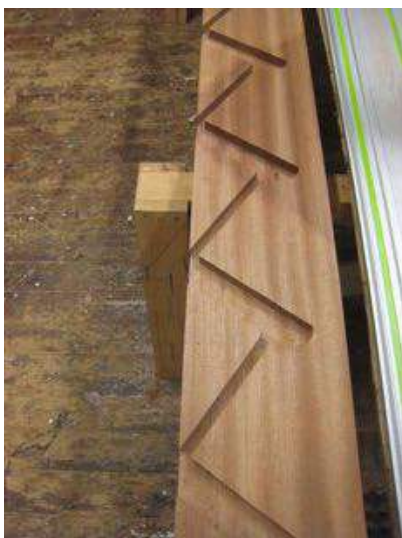
Mahogni plank blir til trappedeler.
