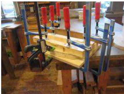
Finerplate får limt på linoleum.
